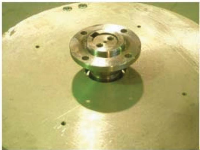
*AFTER DISASSEMBLED BLADE SUPPORT, DISASSEMBLY HUB*
