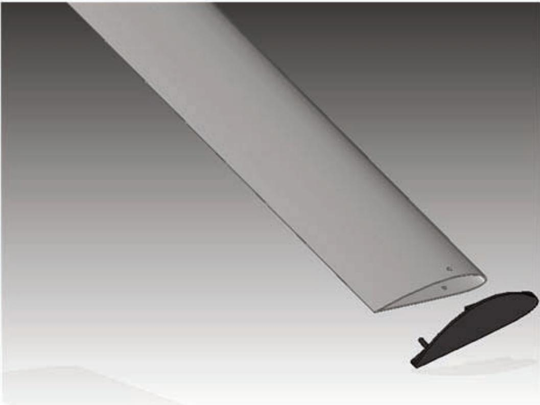
*POSITION THE WINGLET AT BLADE TIP
